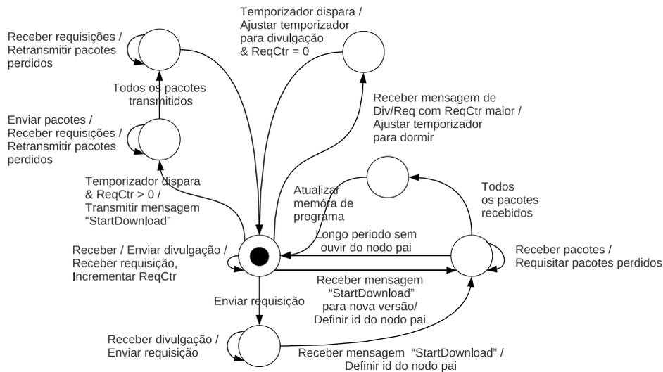
Figura 3. Máquina de estados do protocolo desenvolvido.
