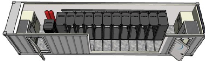
Figura 3.5. Um modelo de data center baseado em contêineres. Extraída de [Enterprise Control Systems 2010].
